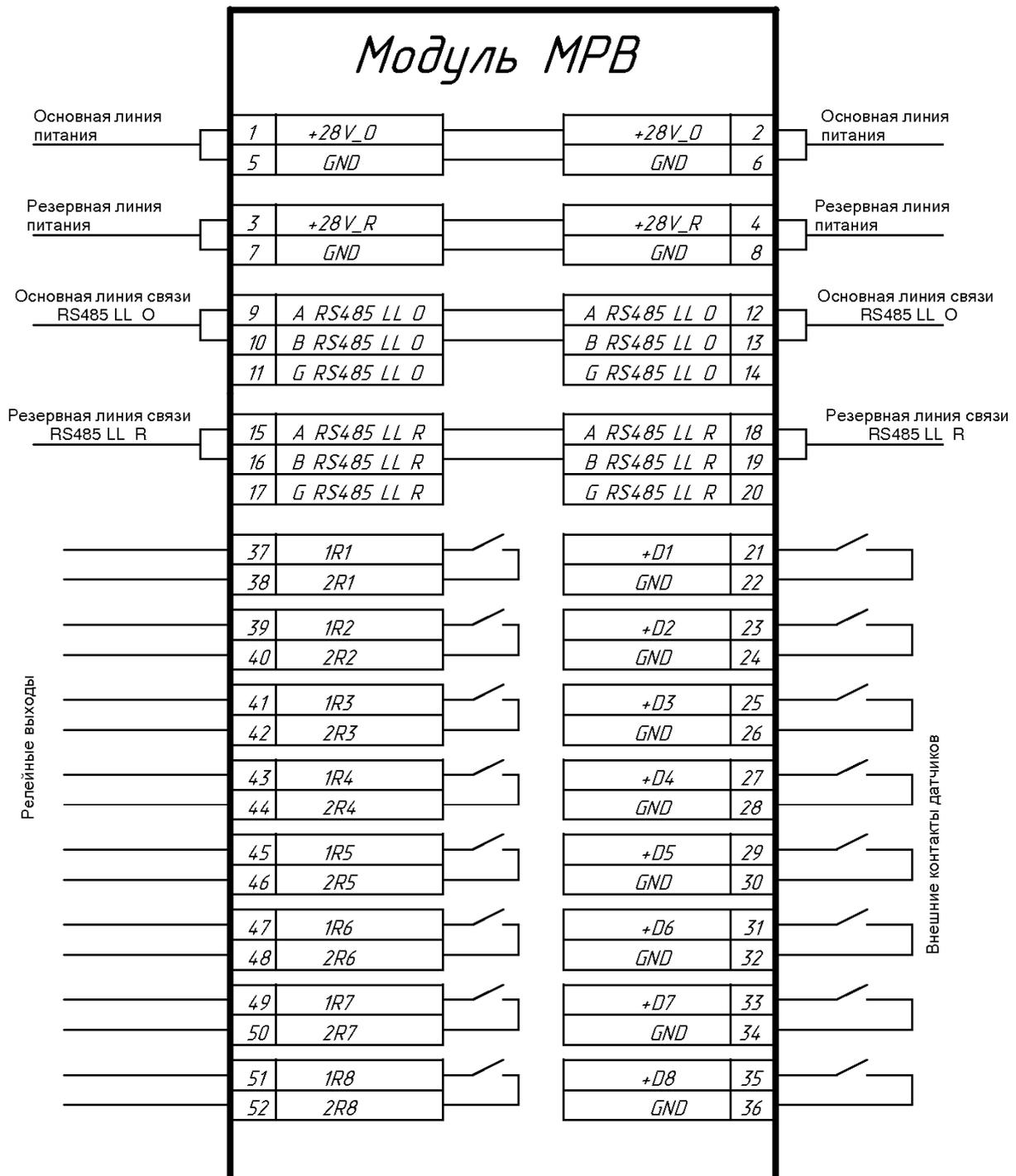
Рисунок 8 – Схема подключения МРВ
