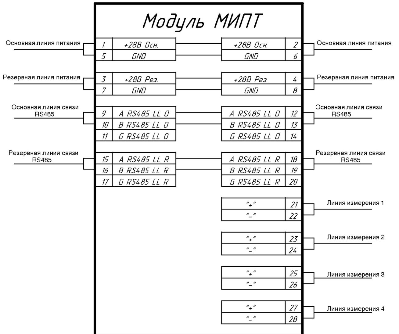
Рисунок 6 - Схема подключения модуля МИПТ
