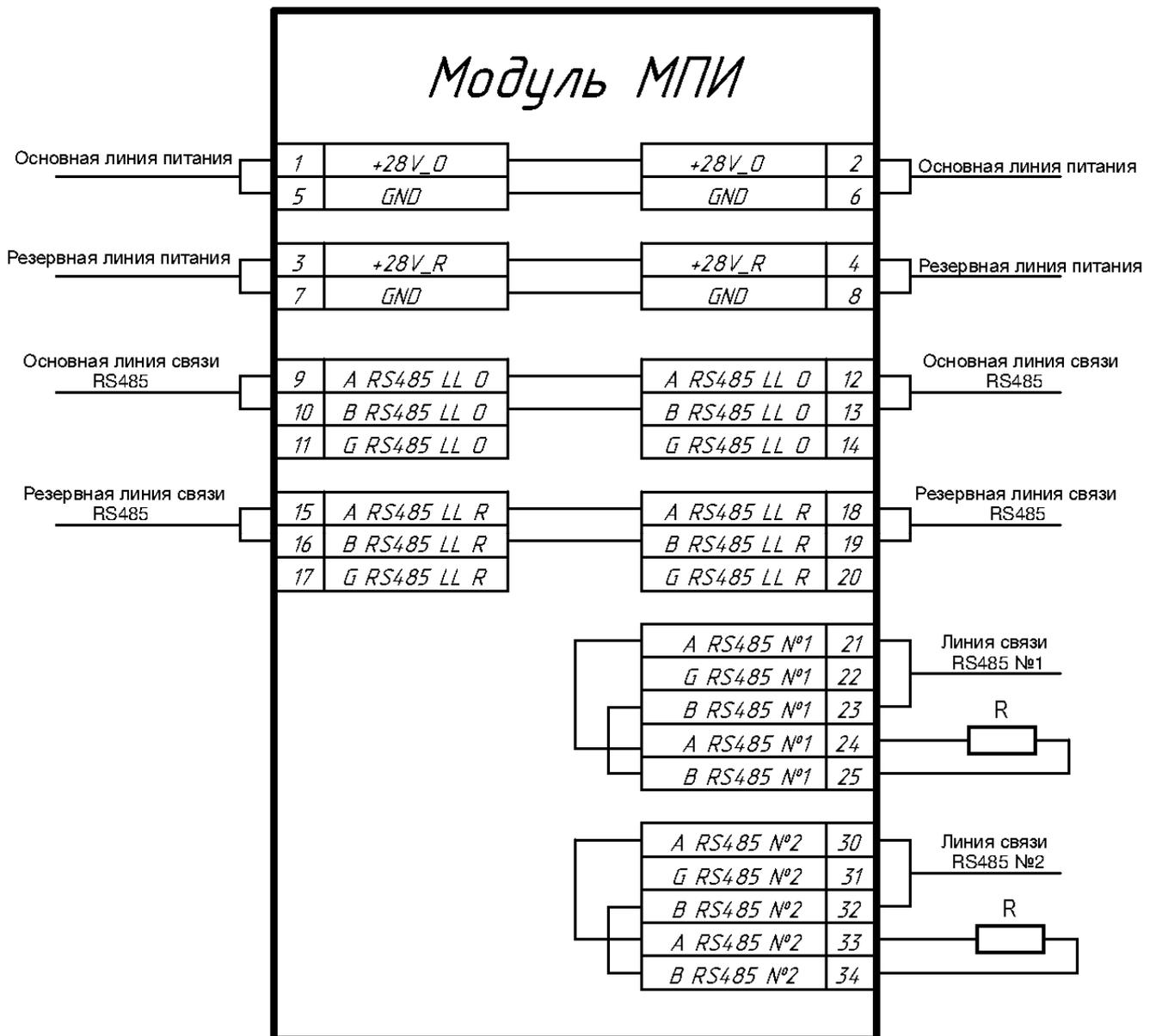
где R –резистор  $120\Omega \pm 5\%$ , подключается непосредственно к контактам модуля
