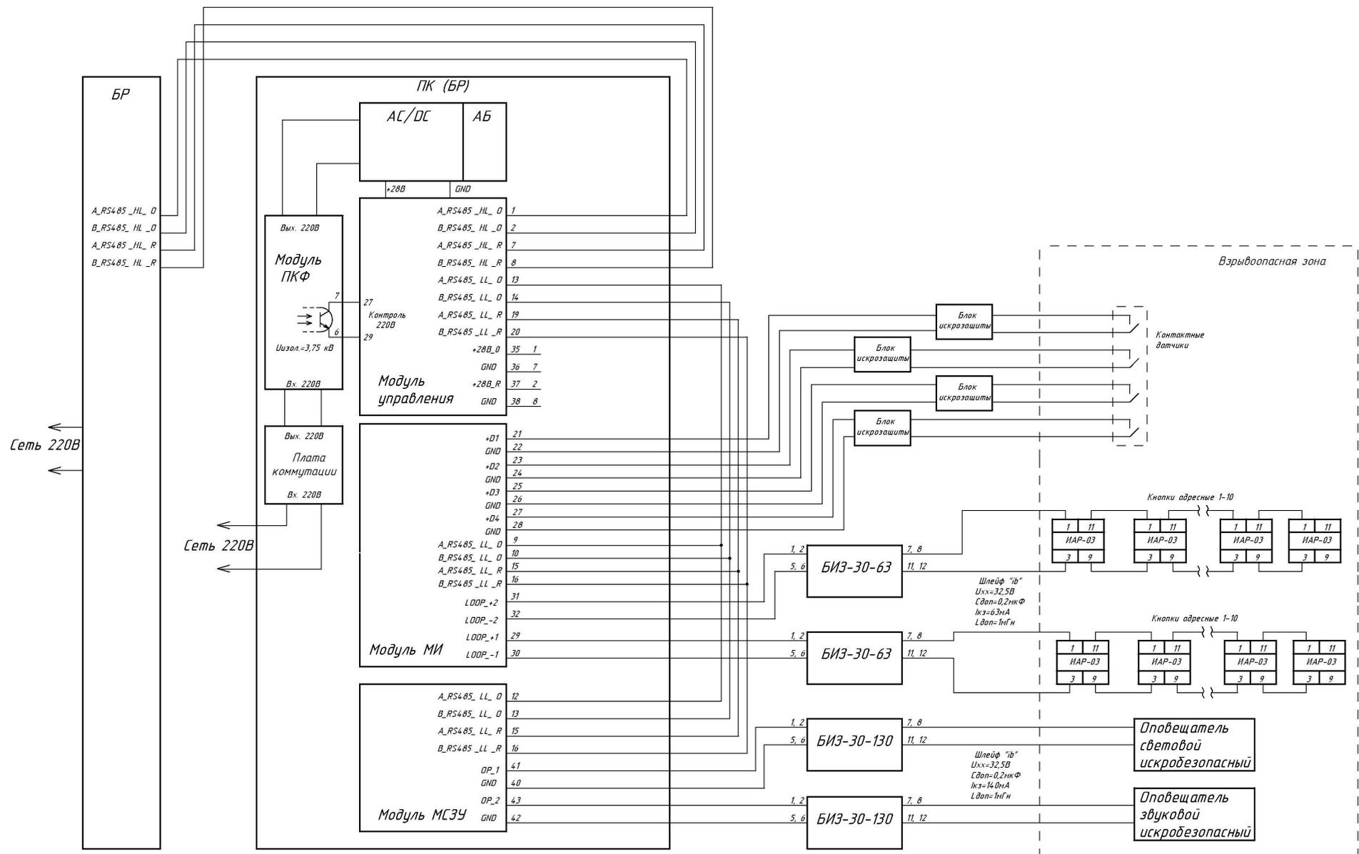
Рисунок 22 – Схема обеспечения взрывобезопасности системы «ПАРУС-РВЧС»
