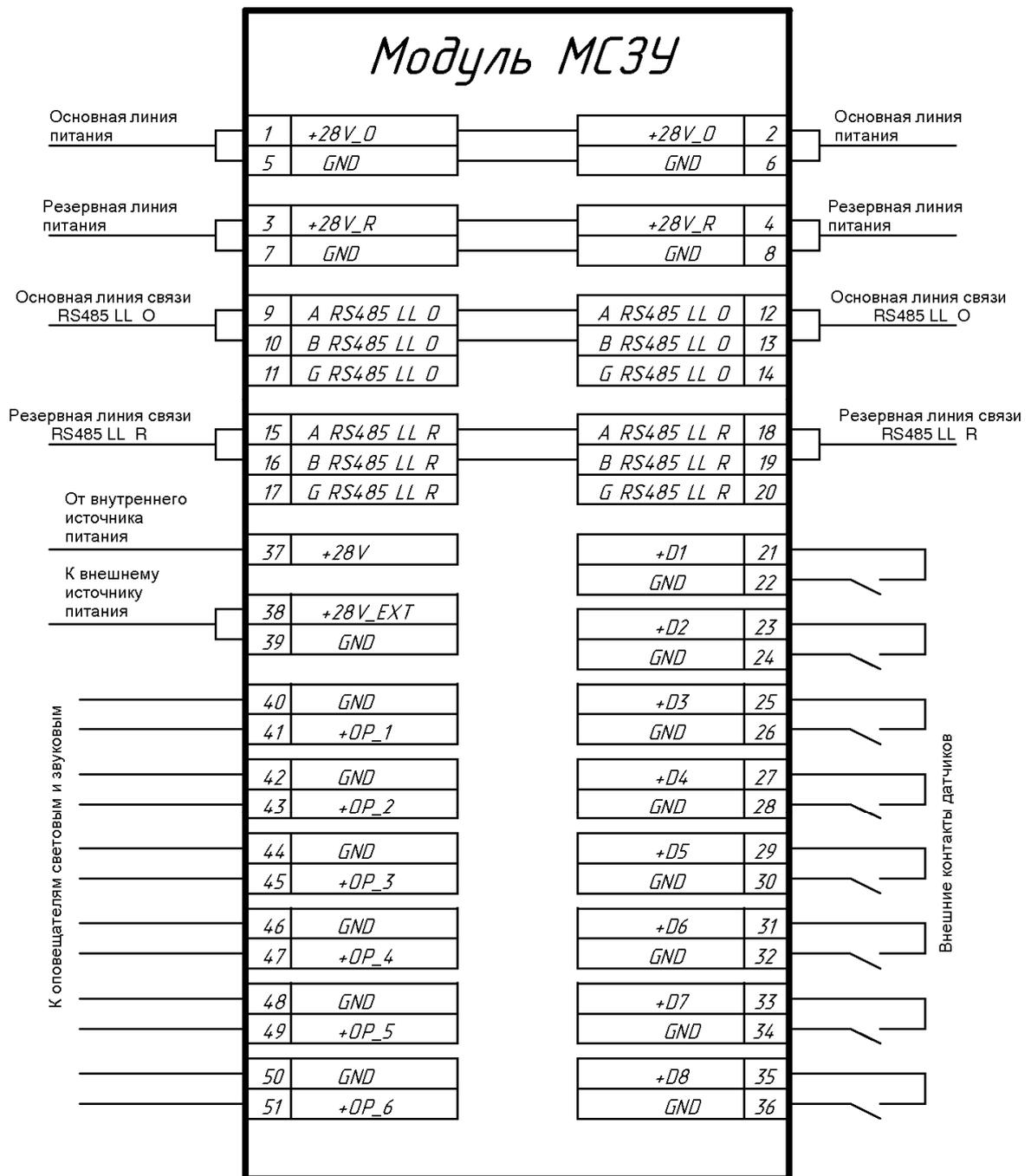
Рисунок 9 – Схема подключения МСЗУ
