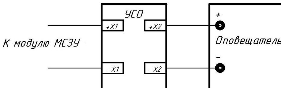
Рисунок 16 – Схема подключения УСО
