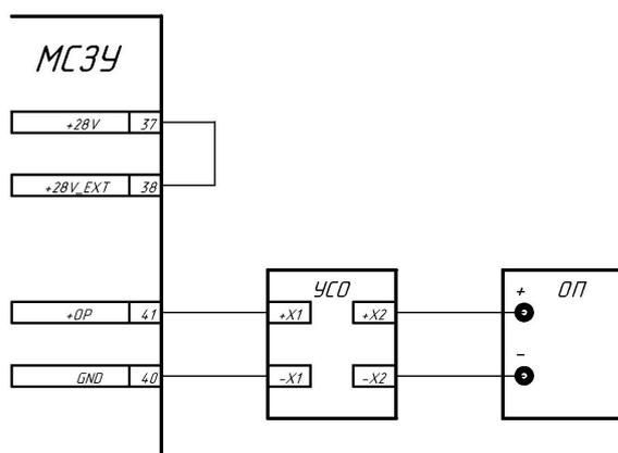
УСО – устройство согласования с оповещателем, устанавливается возле оповещателя;
